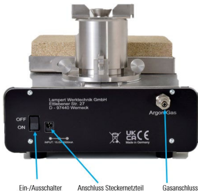
Abb. 4.2 Rückseite Guss Schleuder FUSION mit Anschlüssen und Bedienelement
